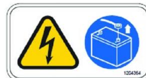
警告ラベル - 感電の危険。本機を点検整備する前に、バッテリーケーブルを外してください。
