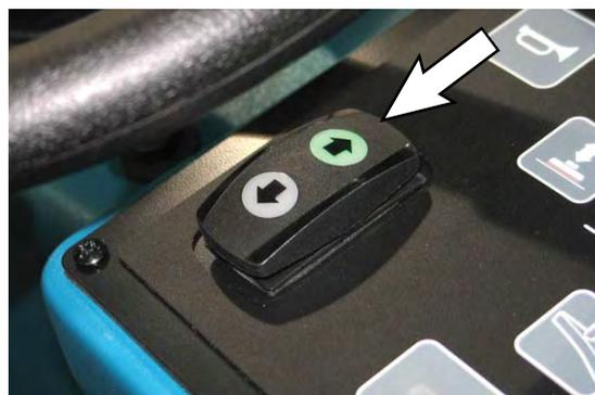
注記：本機を後進させると、自動的にスクイージーが上がり、スクイージーの破損が防止されます。本機が後進設定になっている場合、バキュームファンは少し遅れて閉じます。
