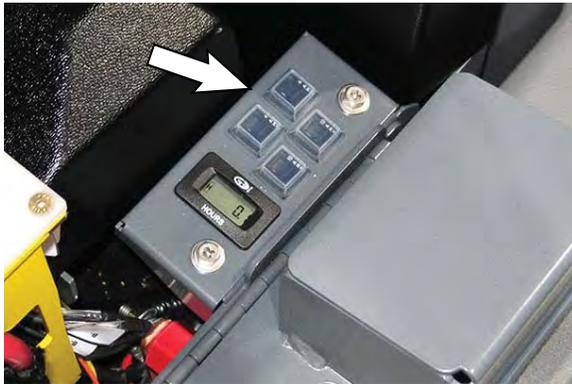
サーキットブレーカーが作動する原因となった過負荷が解消されていない場合、サーキットブレーカーは負荷がなくなるまで電流を遮断し続けます。
