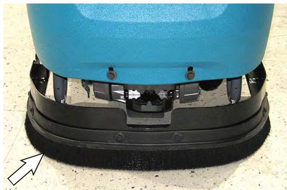
周辺ガードの両側にあるフロント周辺ガードの調整プレートに滑りがないか毎週点検してください。フロント周辺ガードの上縁全体が、床と並行でなければなりません。調整プレートを必要に応じて調整します。
