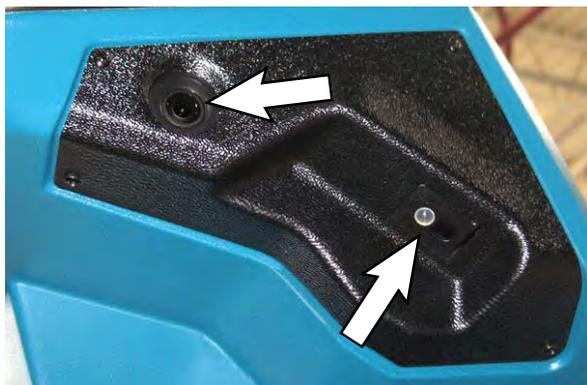
上部および下部LIDARセンサー
