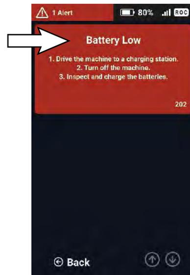
アラートインジケータをリセットするには、本機を停止してからアラートの原因を排除してください。アラートインジケータは、本機を再始動するとリセットされます。
