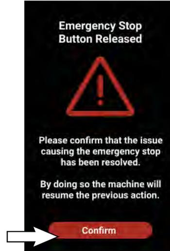
本機がロボットルート上にあったときに、緊急停止ボタン が押された場合は、青の起動 / 一時停止ボタンを押して、ロボットモードで洗浄を再開します。本機がロボット運転を開始したら、洗浄性能を観察して、すべての部品が適切に機能していることを確認します。
