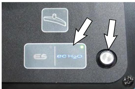
注：ec-H2Oモデルは、初めて使用する際と、水質調整カートリッジの交換後は、ec-H2Oシステムによって、選択した洗浄液流量の設定が自動的に最大75分間無効になります。
