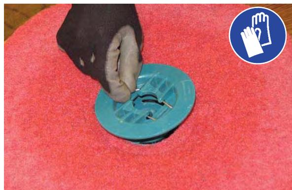
3. 洗浄パッドを裏返すかまたは交換し、洗浄パッドをパッドドライバーの中央に置きます。その後センターディスクを元通り取り付けて、パッドをパッドドライバーに固定します。
