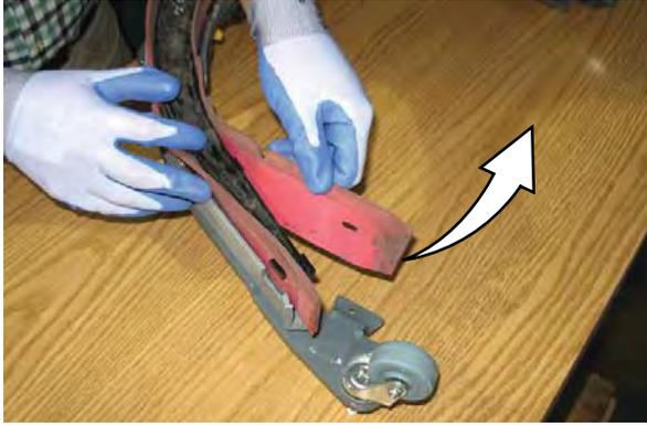
8. リヤブレードを新しい拭き取りエッジに入れ替え、ブレードを再度取り付けます。ブレードのスロットの位置がリテーナのタブと合っていることを確認してください。
