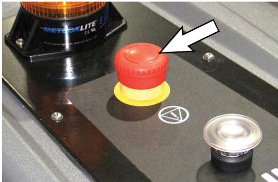
いずれかの緊急停止ボタンを押した直後に、UI タッチスクリーン上に緊急停止ボタン押済み画面が表示されます。UI タッチスクリーン上の指示に従います。
