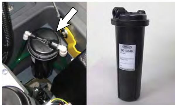
カートリッジには製造日が記載されています。未使用のカートリッジの品質保持期間は製造日から1年です。新しいカートリッジに交換した際には、ec-H20モジュールのタイマーをリセットする必要があります。「ec-H20水質調整カートリッジの交換」を参照してください。
