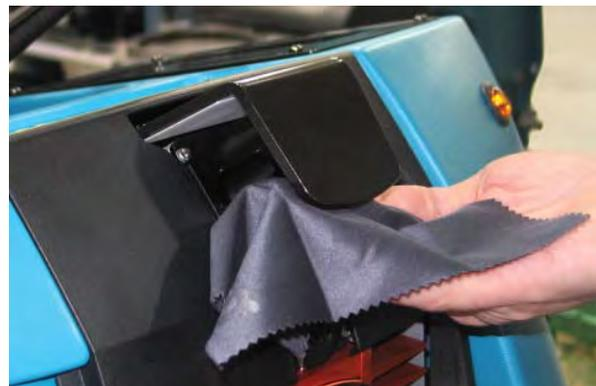
注記：下部LIDARセンサーは清掃面付近に位置するため、前、横、後、および下部表面に汚れ、染み、その他のごみが全くないように特に注意して下さい。フラッシュライトを使用してこれらのセンサー表面を点検し、完全にクリーニングされていることを確認してください。
