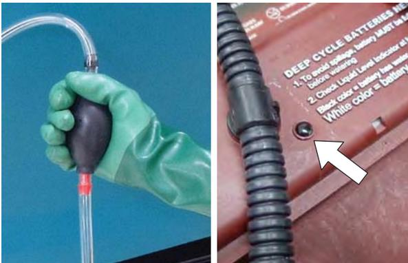
6. 給水後、バッテリーフィルホースのダストキャップを元に戻し、後の使用に備えて手動ポンプのホースをバッテリー室に収納してください。
