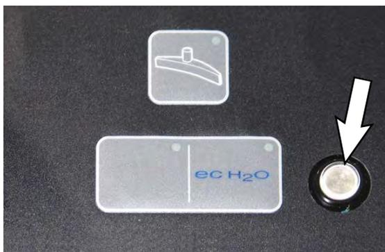
\*洗浄液タンクに洗剤が追加されているか確認してください。ec-H20に洗浄洗剤を入れて運転した場合は、洗浄液タンクを空にして、きれいな水を補充してインジケータライトコードが消えるまでec-H20システムを運転してください。
