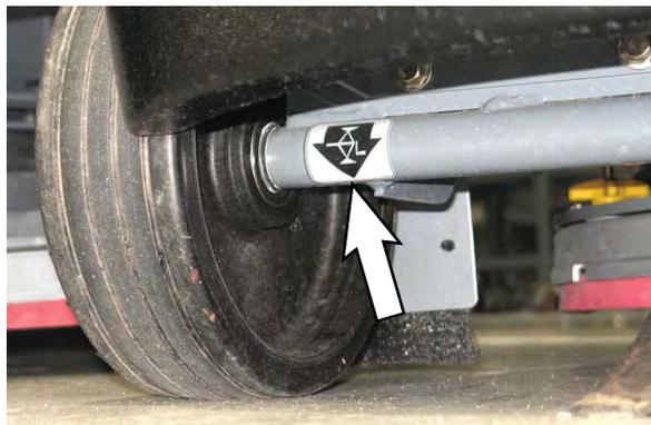
安全のために：本機を点検整備するときは、本機のタイヤを輪留めで止めてからジャッキで持ち上げてください。本機の重量を支えられるホイストまたはジャッキを使用してください。指定された位置にのみジャッキを当ててください。ジャッキスタンドで本機を支えてください。
