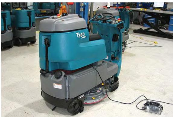
高い位置での場合は、汚水回収タンク/シートを持ち上げて、汚水回収タンクの持ち上げアームで支えます。この高さで、バッテリーコンパートメント内部にあるコンポーネントのメンテナンスを行うのに十分なスペースが確保されます。
