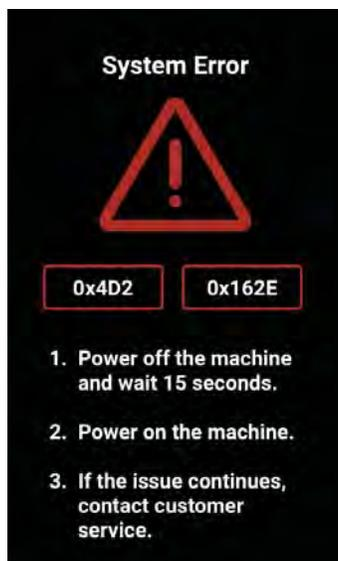
LIDARセンサー/カメラエラー
