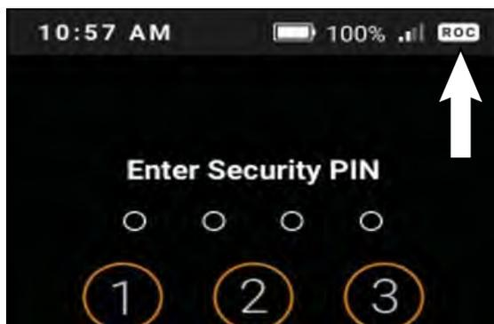
ROCインジケータは、UIタッチスクリーンステータスバーにあります。インジケータが点灯している場合、本機はROCに接続しています。インジケータが灰色の場合、ROCは接続されておらず、携帯電話とのペアリングはできません。
