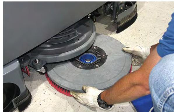
5. 新しいブラシまたはパッドドライバーを洗浄ヘッドの下に押し込み、磁気によりブラシまたはパッドがドライブハブにしっかりと固定されるまでブラシまたはパッドドライバーを上げます。
