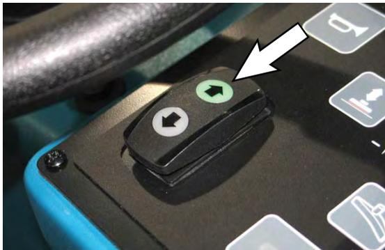
方向スイッチの下部を押すと、本機が後進します。本機が後進に設置されている場合は、スイッチの下部にある後進矢印ライトが点灯します。
