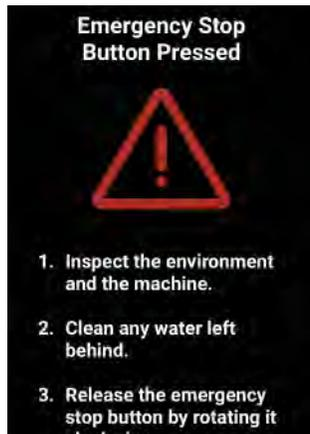
本機停止用に使用した緊急停止ボタンを 右に回し、緊急停止機能を解除します。緊急停止ボタンを解除した直後に、UI タッチスクリーン上に緊急停止ボタンリリース済み画面が表示されます。[確認] をタッチします。
